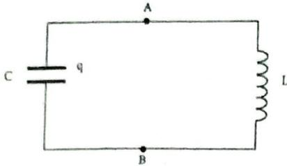
Le montage ci-contre comprend, montés en série, un condensateur de capacité  $C = 0,10 \mu\text{F}$  et une bobine d'inductance  $L = 1,0 \text{ H}$  et de résistance négligeable.
